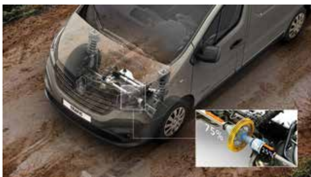
Renault X-Track - Différentiel à glissement limité © Pagecran
