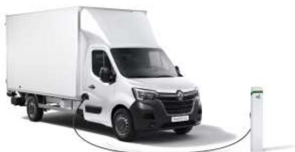
Master Z.E. : nouvelle version châssis-cabine, transformation grand volume 20m 3 avec hayon, charge utile 1000 kg. @Renault Marketing 3D-Commerce
